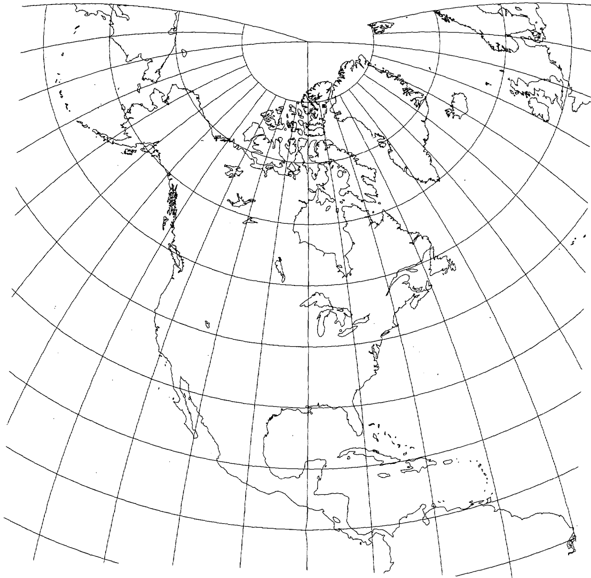
Figure 69b.—Chamberlin Trimetric projection of North America, 10° graticule. Three source points for this map, as selected by the National Geographic Society: (1) latitude 55° N., longitude 150° W.; (2) latitude 55° N., longitude 35° W.; (3) latitude 10° N., longitude 92°30' W.
